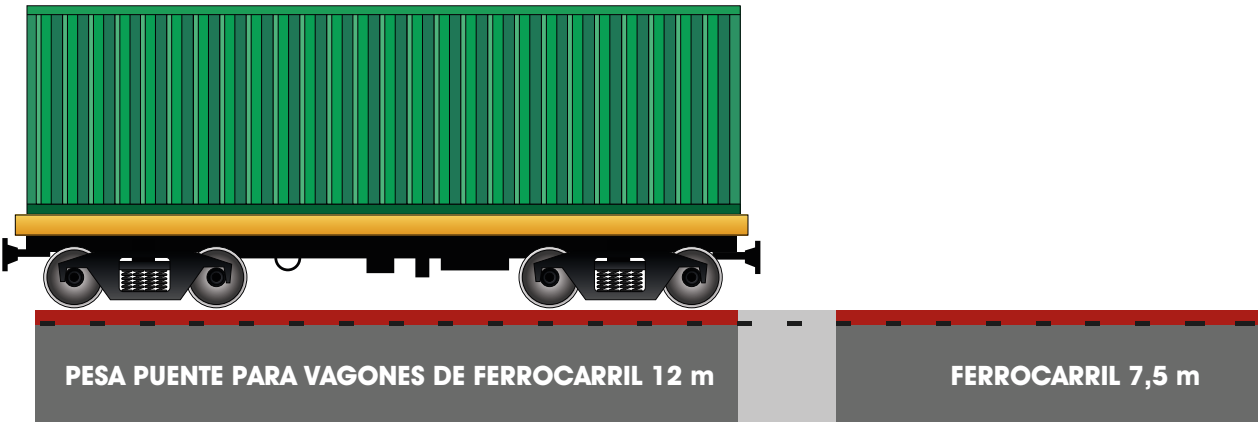
Ejemplo configuración de pesaje en suma (vagón corto)
