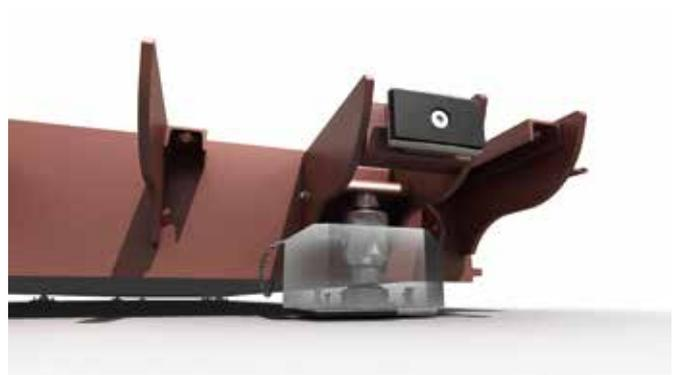
**Soportes de las células de carga de acción oscilante de acero inoxidable** para eliminar cualquier fuente de daño por fuerzas transversales. **Protecciones de las células galvanizadas**, imprescindibles para mantener la zona de alojamiento libre de barro, residuos, etc.
